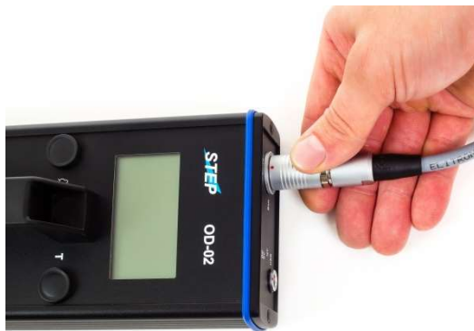
Fig. 23) Desconexión del conector del cable de la sonda de medición.
