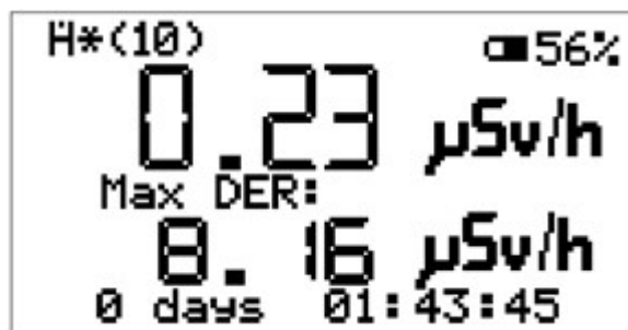
Fig. 16) Indicación de la pantalla en el modo de medición \mu\text{Sv/h} .
