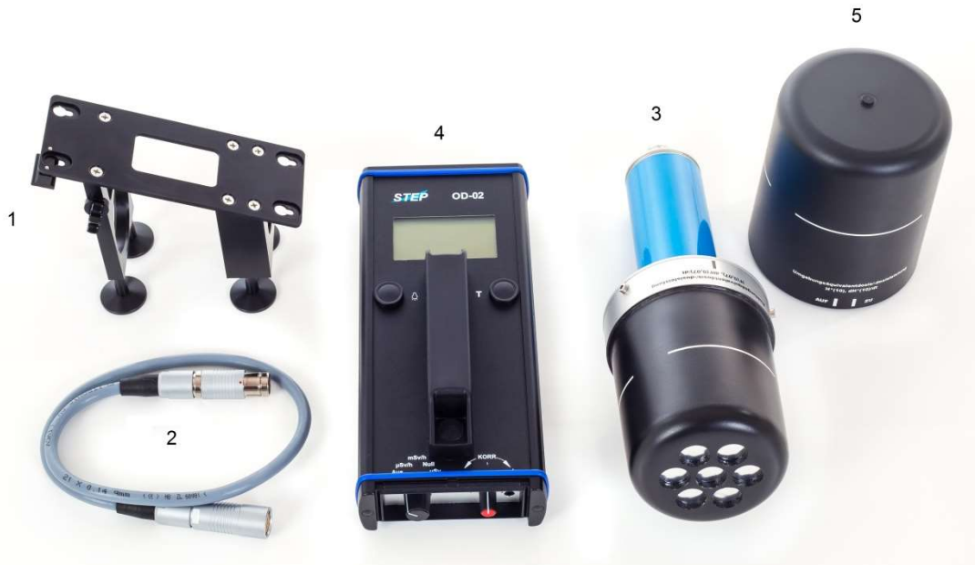
Fig. 1) Componentes estándar del OD-02 (alcance del suministro)
