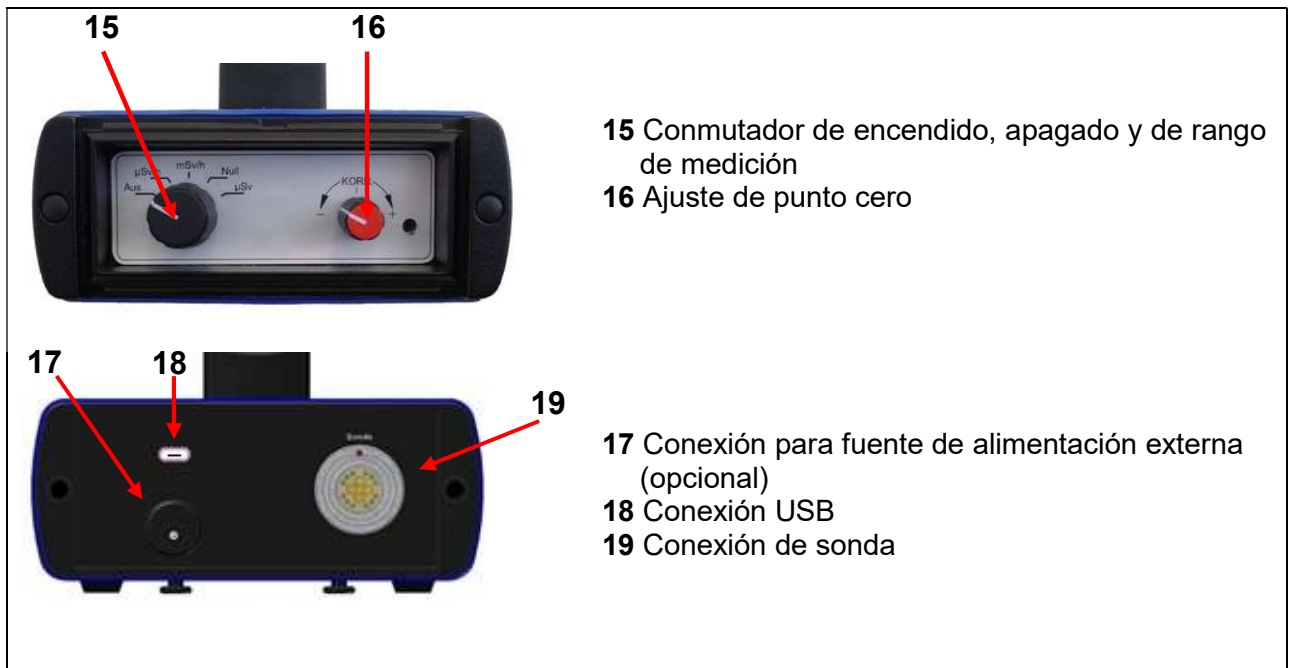
Fig. 4) Elementos de mando y conexiones en las caras de los extremos del equipo
