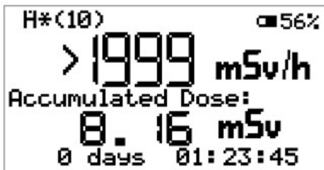
Fig. 18 a) Indicación del desbordamiento del rango de medición "Tasa de dosis".
