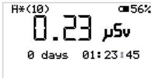
Fig. 17) Indicación de la pantalla en el modo de medición de dosis \mu\text{Sv} .
