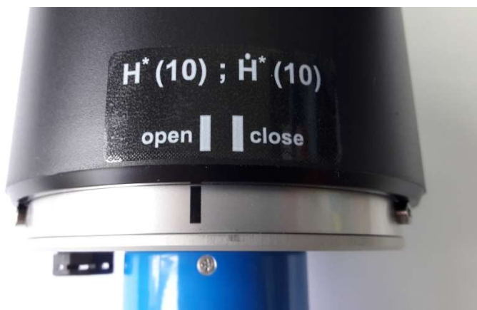
Fig. 14) Colocación de la caperuza de refuerzo de pared
