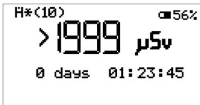
Fig. 18 b) Indicación del desbordamiento del rango de medición "Dosis".
