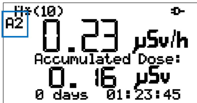
Fig. 30) Se ha alcanzado el umbral de alarma A2 (el símbolo "A2" permanece como señal)
