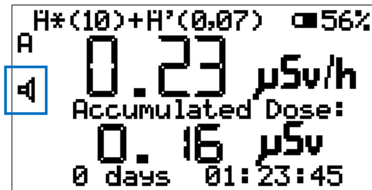
Fig. 33) La señalización acústica está activa
