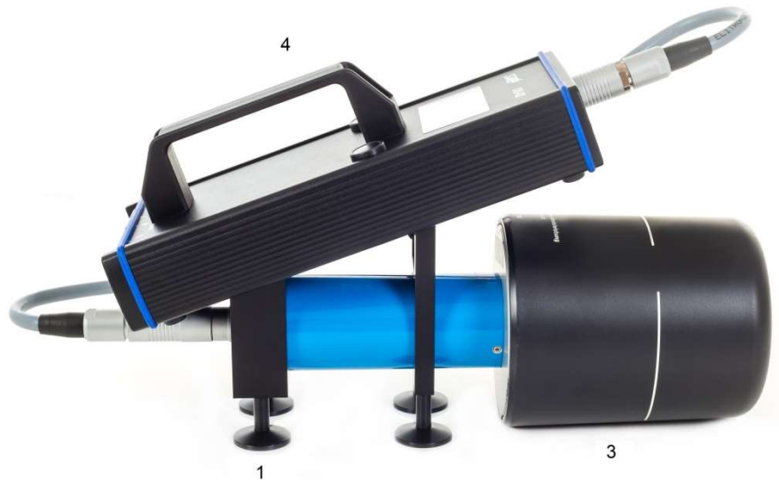
Fig. 20) Unidad de visualización y sonda enganchados en el soporte del equipo.
