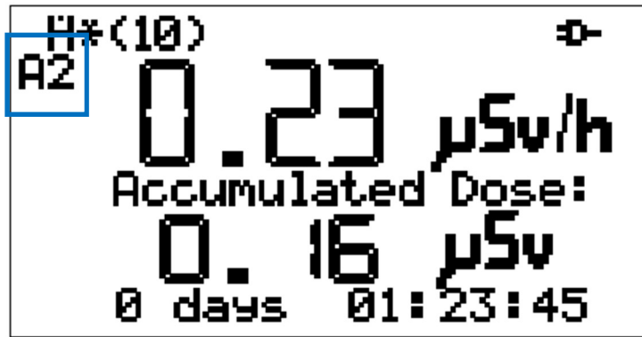
Fig. 29) Se ha alcanzado el umbral de alarma A2 en este momento (el símbolo "A2" parpadea)
